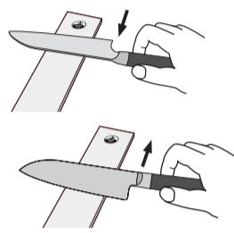
Le cuir à couteau vient à bout des poussières les plus fines. Passe le couteau sur le cuir en alternant des deux côtés de la lame. Attention à toujours aller dans le sens du dos de la lame comme si tu étais du beurre.
