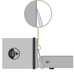
Stelle vor der Anwendung der Edelkorund Schleifsteine sicher, dass dein Messer mit dem HORL Diamant Standard beidseitig eingeschliffen ist. Die Schneide sollte grafffrei sein.
