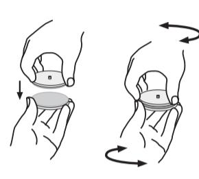
Nettoie soigneusement les surfaces d'aiguisage, le support magnétique et le couteau avant et après chaque séance d'aiguisage. Tu peux nettoyer les pierres #3000/#6000 en les frottant légèrement les unes contre les autres dans un mouvement circulaire.
