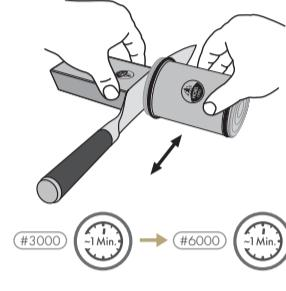
Utilise l'aiguiseur et son support comme à l'habitude. Afin d'obtenir un résultat optimal, aiguis aussi longtemps les deux côtés de la lame de façon régulière et constante.
