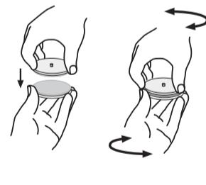
Limpia a fondo las piedras de afilar, la guía de afilado y el cuchillo antes y después del afilado. Puedes limpiar las piedras #3000/#6000 al colocarlas una contra otra y realizar suaves movimientos circulares.
