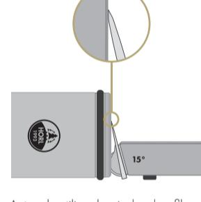
Antes de utilizar la piedra de afilar de corindón fino, asegúrate de que has afilado el cuchillo por ambos lados con el disco abrasivo de diamante HORL. El filo no debe presentar rebaba.
