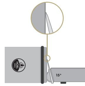
Avant d'utiliser la pierre en corindon, veille à ce que ton couteau est appris parfaitement l'angle d'affûtage avec le HORL diamant standard. La lame doit être sans salissure.
