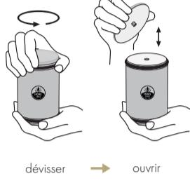
Dévissez la surface d'affûtage de l'aiguiseur et remplacez-la par une des pierres #3000/#6000. Vissez la surface d'affûtage avec précaution et une force modérée.
