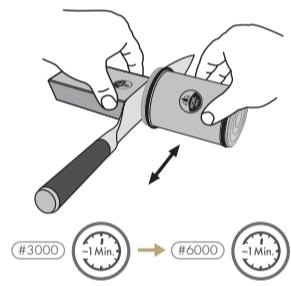
Wende den Rollschleifer und die Schleiflehre wie üblich an. Für ein optimales Ergebnis schleife beide Seiten der Klinge gleich lange.
