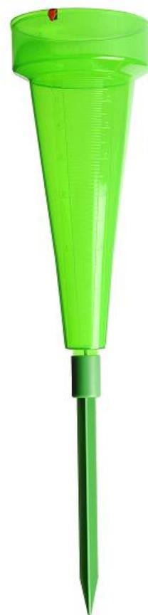
Pluviomètre 60 mm d'eau au m<sup>2</sup> à lecture directe afin de mesurer les précipitations et d'en faire le cumul
