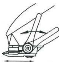
Utilisez le levier pour un réglage fin. Le levier dispose de 4 hauteurs de coupe de 0,9 mm à 1,2 mm. Le levier vous permet d'ajuster la proximité de votre coupe entre les longueurs de peigne de guidage. Ajustez le levier vers le haut pour une coupe plus serrée et vers le bas pour une coupe plus longue.
