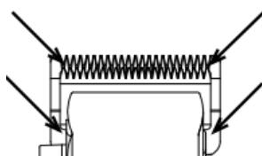
Pour l'huiler correctement, l'appareil doit être maintenu de manière à ce que les lames soient en position basse, ajoutez l'huile comme indication de flèche. Appliquez une ou deux gouttes d'huile de lubrification sur la base des lames mobiles.
