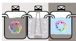
En général, une micro-station se compose de 3 cuves, chacune de ces 3 phases se déroule donc dans une cuve spécifique. Une fois ces étapes passées, l'eau est assainie\*. Les bactéries présentes naturellement dans les eaux usées ont un rôle important dans le bon fonctionnement de la micro-station. Un apport régulier de nutriments est très important pour permettre aux bactéries de se développer et de jouer leur rôle dans la dégradation des matières premières présentes.
